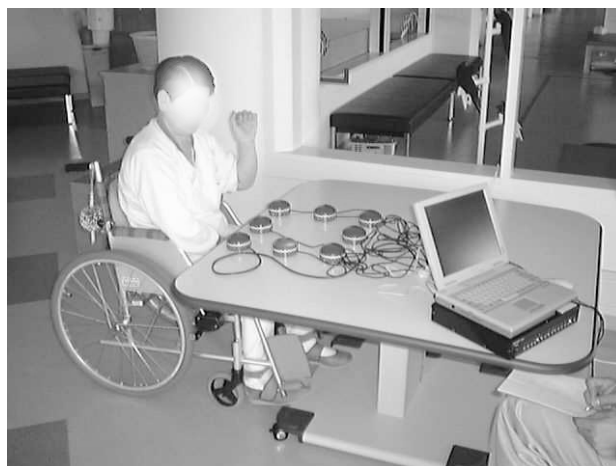
図5 使用場面例 ノートパソコンの下の黒い箱が中継器
